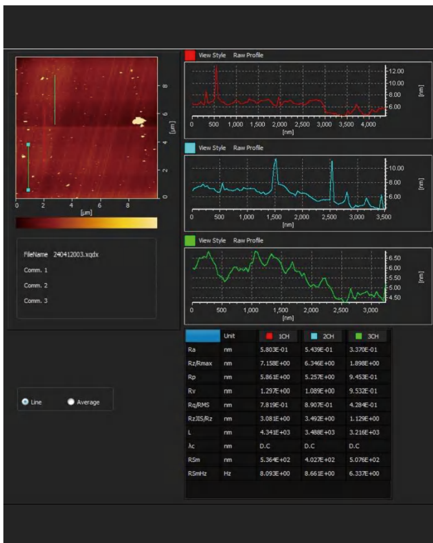
图4. 电子级高纯金刚石的原子力显微镜测试图
